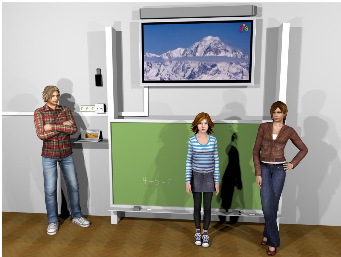
Abb. 1: Montagevorschlag Großbildschirm (Körpergrößen 180, 150, 162cm)
